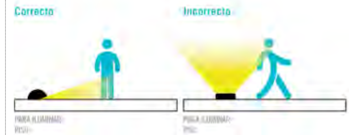
FIG.14. EJEMPLO ILUMINACIÓN HACIA EL PISO
