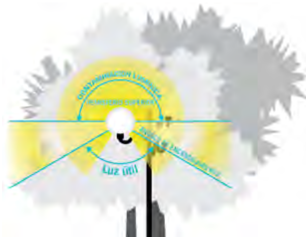
FIG.3. TIPOLOGÍA DE POSTE Y LUMINARIA USADA FRECUENTEMENTE EN CHILE
