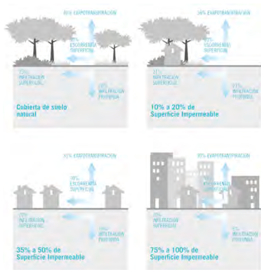
FIG.27. RELACIÓN ENTRE PRESENCIA DE VEGETACIÓN E INFILTRACIÓN DE AGUAS LLUVIAS
